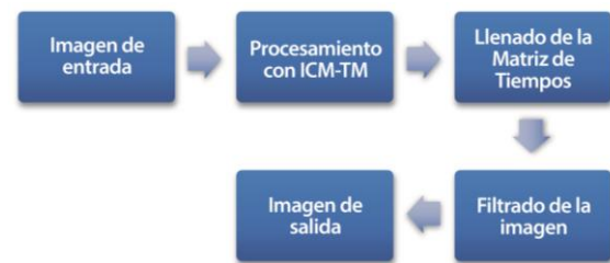
Fig. 5. Diagrama del algoritmo propuesto
